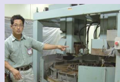
回転ラベリング試験機(路面の耐久性を評価できる試験機の一部)「道路舗装用材料がタイヤの走行によって受ける影響を評価する」と解説する、青木課長代理。
