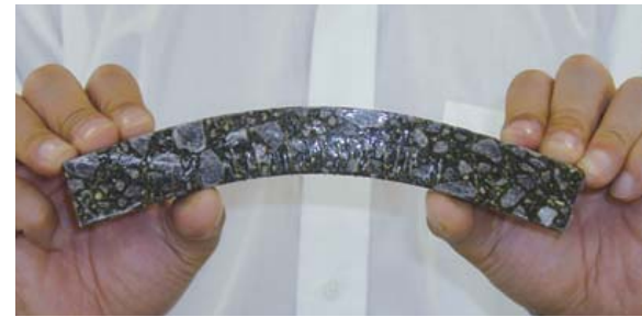
高いたわみ性(変形追従性)を示すリラクスファルト
