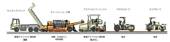
通常の舗装機械のダンプとアスファルトフィニッシャの間に「チャージャーヒータ車」1台を加えた編成です。これにより、既設舗装路面を加熱・かき ほぐし直後に上層混合物を舗設できるため、既設舗装路面と上層混合物の付着性を確保し、品質の確保とコストダウンを同時に実現します。
