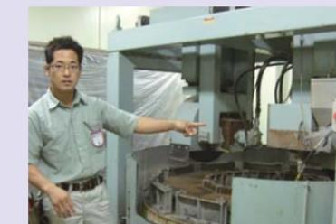
回転ラベリング試験機(路面の耐久性を評価できる試験機の一例)「道路舗装用材料がタイヤの走行によって受ける影響を評価する」と解説する、青木課長代理。
