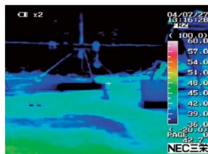
セラクールシステム舗装の路面温度
