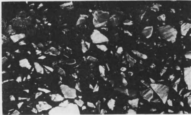
トベカ式アスファルトコンクリート断面図
