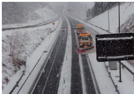
梯団除雪作業状況
