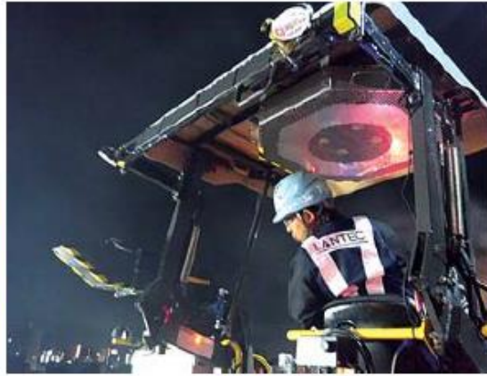
運転席上部に取り付けられたファンユニット
