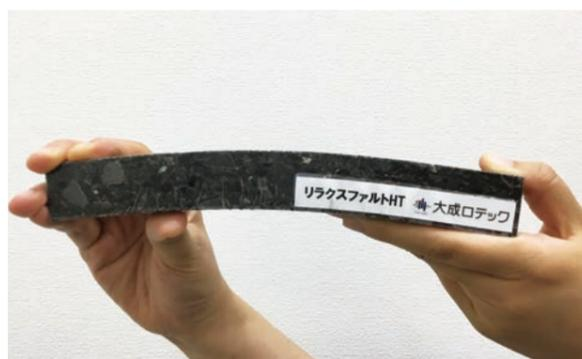
リラクスファルトHTを使用したアスファルト混合物は、ひび割れが生じにくく流動わだち掘れの発生も抑制できますので、重交通路線の長寿命化舗装として活用できます。
