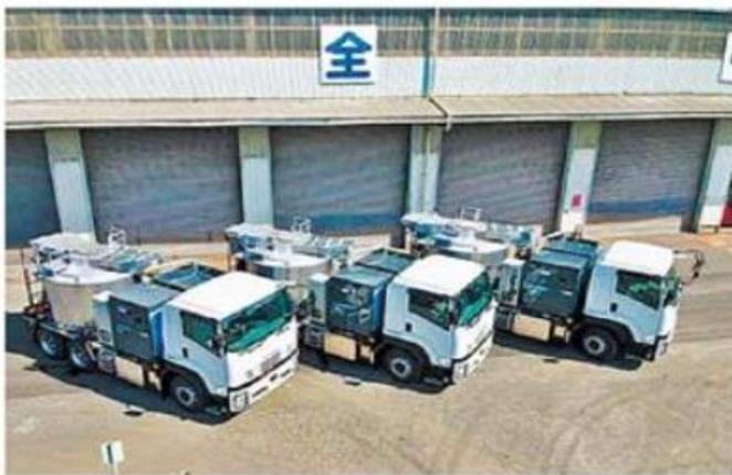
め、加熱しながらの走行はできなかった。新たに導入した車両では、電気加熱式を採用することで走行中でも材料を加熱できるようになり、安定した品質の材料を現場に供給することが容易となった。
