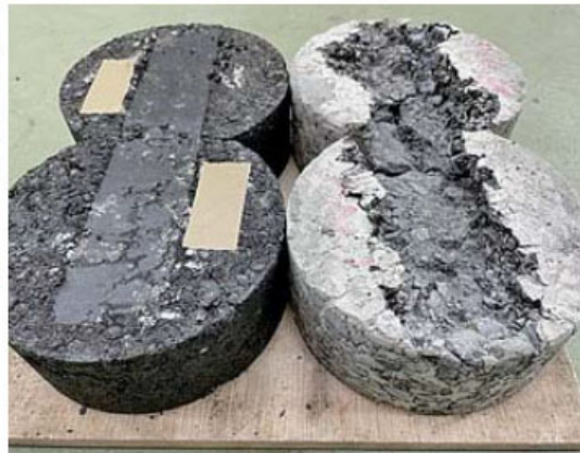
HWT試験後の供試体（TRタフパイプ ® 、半たわみ性混合物）
