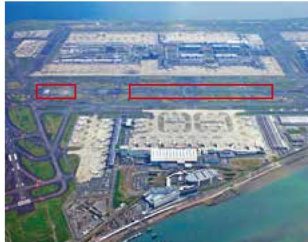
東京国際空港(羽田空港)では、首都圏空港の機能強化および2020年に開催予定であったオリンピックに対応するため、飛行経路の変更対応(北側進入ルート)を含むA滑走路の大規模な改良工事が行われました。本工事はこのプロジェクトの一端を担い、A滑走路の一部(約1km/全長3km)のAs舗装打換と北側進入に対応するための航空灯火施設の設置を行ったものです。
