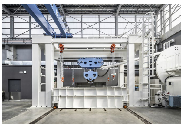
写真5 「道路床版のラボ」に設置した輪荷重試験機
