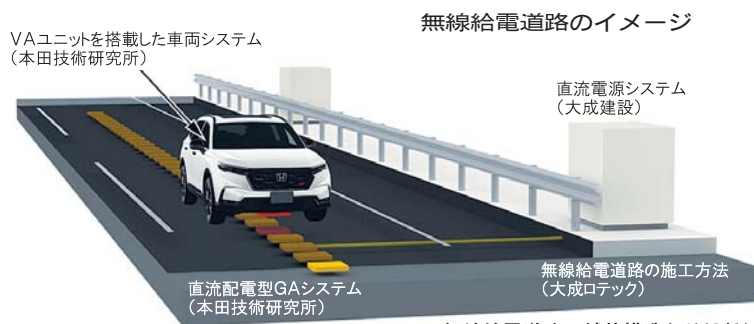
無線給電道路の舗装構造など(3社)
